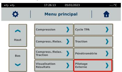
Un message « Attente connexion indique que le TX-700 est en attente de communication avec le logiciel RheoTex (voir mode d'emploi du logiciel RheoTex pour la configuration). Lorsque la communication est ouverte, le TX-700 affiche des valeurs en Force et distance.
