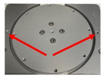
Les vis à main sont utilisées pour fixer la table sur les orifices présents sur la base du TX-700. Il est nécessaire de positionner le plateau rotatif du TX-700 à la position la plus basse.
