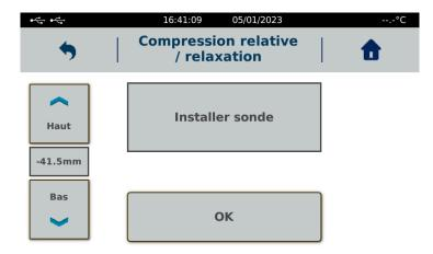
Installer la sonde et ajuster la position de départ du bras avec les touches Monte et Baisse afin de réduire le temps de cette action. Appuyer sur « OK ».
