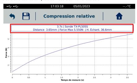
L'instrument vous affiche la courbe mesurée avec les informations suivantes : Temps de la mesure, sonde utilisée, distance atteinte correspondant à profondeur exprimée en % (voir méthode), force maximum mesurée à la profondeur en % et hauteur de l'échantillon (selon seuil de détection utilisé dans la méthode).
