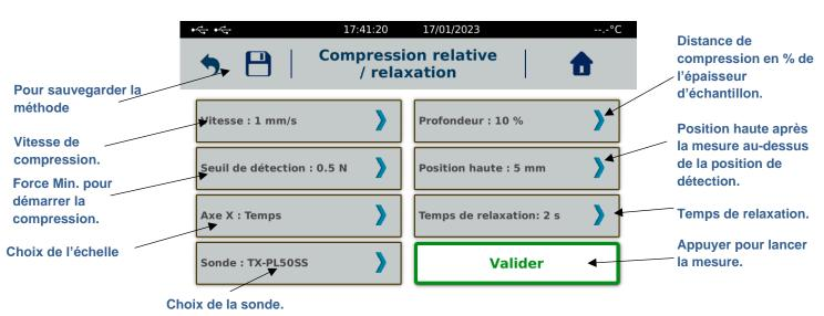
Le mode « Compression relative » nécessite que la position zéro soit détectée, c'est-à-dire la base sur laquelle l'échantillon sera posé. Cliquer sur « Valider » pour obtenir l'écran suivant.
