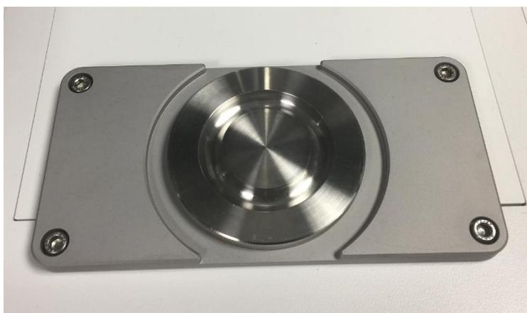
Les modèles N500426 et N500427 sont équipés d'un puits permettant l'insertion des godets MB-SV et MB-DIN.
