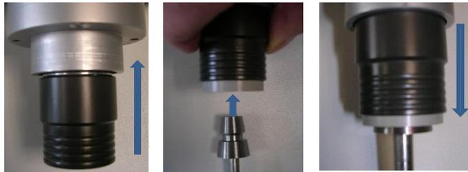
Pour une bonne rotation veuillez respecter l'alignement de la flèche sur le cône de mesure et de la flèche sur l'accouplement.
