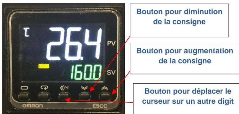
Pour régler la température sur les modèles N500401, N500411, N500421, N500431 et N500426 veuillez consulter la section 2.9.
