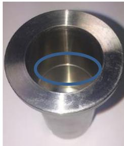
Remettre le godet MB-DIN dans le puits de l'instrument. Installer de nouveau le mobile MK-DIN dans l'accouplement AC265. Descendre avec l'ascenseur jusqu'à ce le produit à mesurer soit en contact avec le mobile MK-DIN. Cliquez sur « GAP » pour que le mobile atteigne la position que vous avez réglé au préalable.
