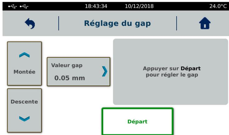
Entrer la valeur de position de mesure désirée en sélectionnant « Valeur GAP ». Pour un système de mesure possédant une troncature, cette valeur doit être fixée à 0.05mm (voir le certificat du système de mesure pour la valeur réelle de cet entrefer). Pour un système sans troncature, la position doit être réglée à 0.01mm. Pour une géométrie plateau, la position de mesure peut être réglée entre 0.150 mm et 2 mm.
