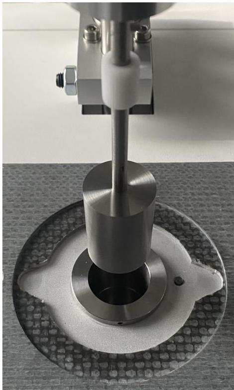
Choisir des paramètres de mesure simple ou un programme dans l'instrument (voir section 2.3) pour avoir accès au réglage de l'entrefer (voir section 3.3). Assurez-vous que la géométrie de mesure sélectionnée est correcte (i.e. MS-DIN11).
