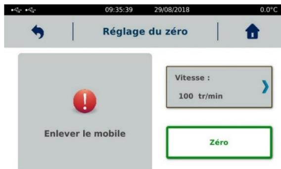
Cette opération doit se faire sans mobile. Lorsque le zéro est terminé, vous pouvez cliquer sur « Valider » et le frottement interne du moteur sera automatiquement sauvegardé dans la mémoire du rhéomètre. Si un problème survient lors du réglage du zéro, veuillez réessayer. Si le problème persiste, veuillez contacter la société LAMY RHEOLOGY.
