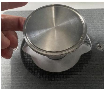
Positionnez l'adaptateur pour godet MB-DIN et MB-SV. L'insérer suffisamment pour que celui-ci ne dépasse pas.
