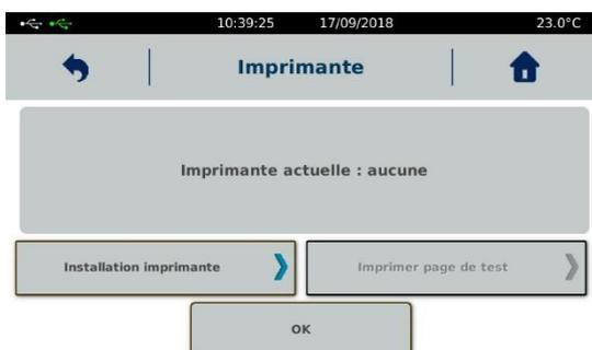
L'instrument permet d'être connecté à toutes les imprimantes dont le protocole d'impression est PCL5. Cela englobe de nombreuses imprimantes format A4. La connexion se fait sur le port « USB » à l'arrière de l'instrument. Une fois l'imprimante connectée, il vous suffit de cliquer sur « Installation imprimante ».
